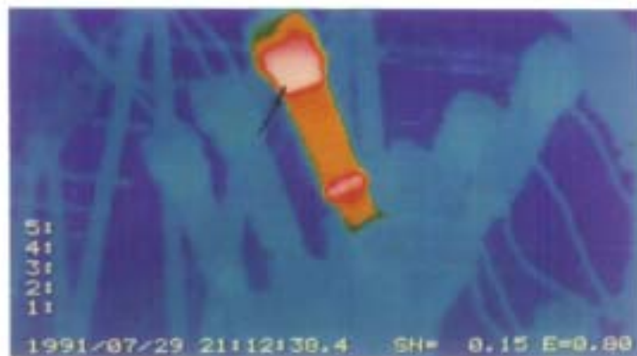
图 H12 少油断路器动静触头接触不良
