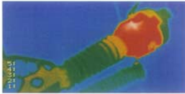
图 H14 少油断路器静触头基座接触不良
